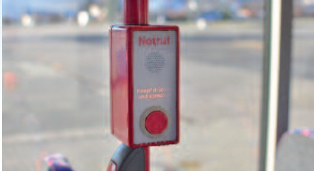
Ein Lautsprecher im Anhänger für Durchsagen durch das Fahrpersonal und zum Absetzen von Notrufen durch Fahrgäste.
